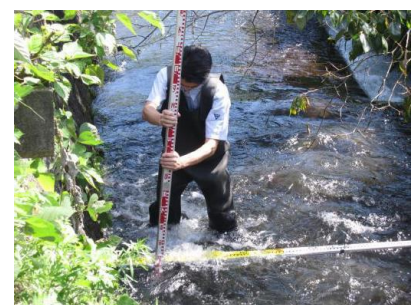
図 小水力発電事業化の候補地での簡易流量調査の様子 出典：平成25年度第1回小田原再生可能エネルギー事業化検討協議会資料
